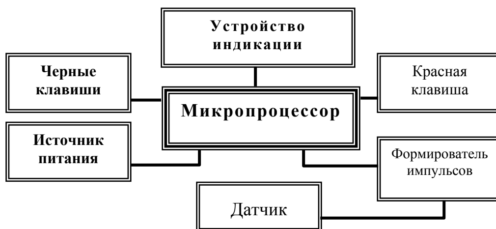
Рис. 3.1. Структурная схема МКРС
